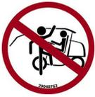
Il est interdit de transporter des personnes (en les accrochant de l'extérieur) sur la machine de pose !
