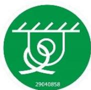
Œillet d'arrimage pour fixer l'appareil/la machine au véhicule de transport au moyen de chaînes ou de sangles.
