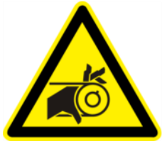
Warnung Handverletzung durch Riemenantrieb 2904.0451
