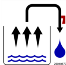
Tappe av kondensvann daglig 2904.0673
