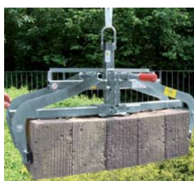
Concrete Step Handles TSZ-MAXI
