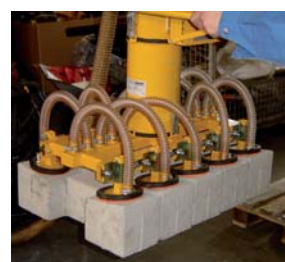
Vícenásobná sací deska pro odtokové bloky
