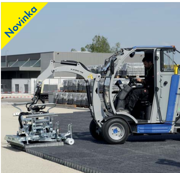
VM-X-PAVERMAX premium – pokládač dlažby s klešťemi HVZ-UNI-II
