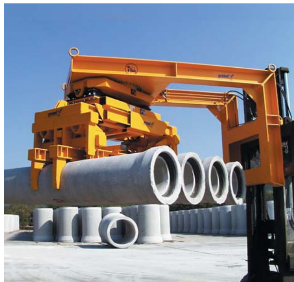
Univerzální kleště na potrubí URS-ST
