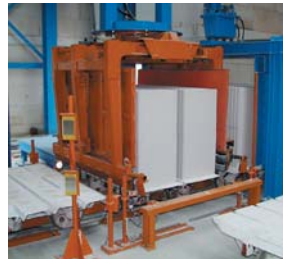
Kleště na tvárnice STAZ s třístrannou rukou
