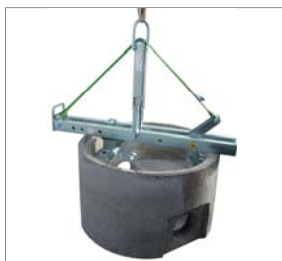
Kleště na kladení skruží a kónusů SVZ-ECO
