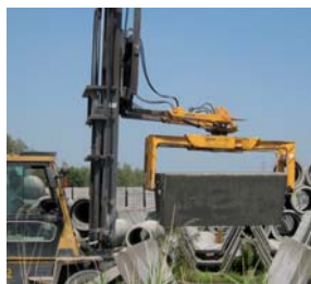
Kleště STAZ pro vysokozdvizný vozík s bezpaletovým zdvihem
