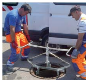
Kleště SRZ-M na rámy kanálových poklopů
