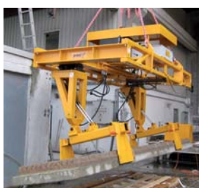
Ustavovací zařízení protihlukových stěn
