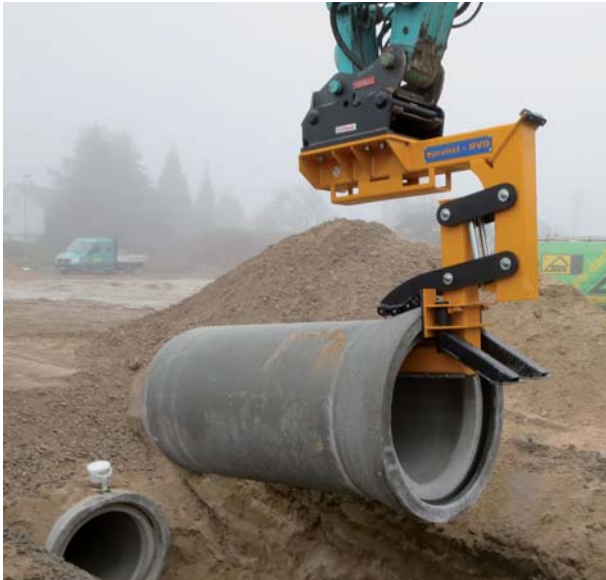
Chwytaik do układania rur RVD-4,5-ECO
