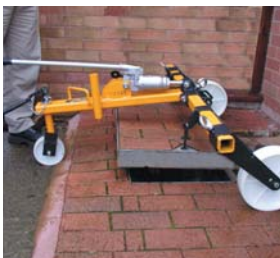
Hydrauliczny podnośnik kłap studzienek SDH-H-15
