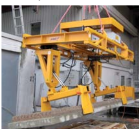
Chwytnak do ustawiania ekranów dźwiękoszczelnych
