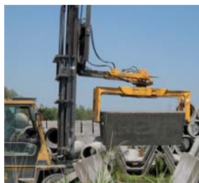
Chwytnak do wózka widłowego do elementów prefabrykowanych
