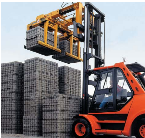
Chwytnak podwójny z teleskopowo rozsuwanym wysięgnikiem żurawia STAZ-DZ-II
