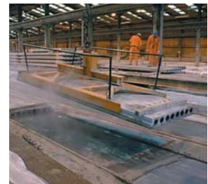
Chwytnak do przenoszenia płyt stropowych VZ-D
