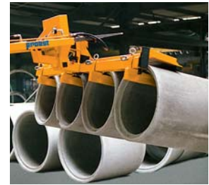
Przyrząd do obracania krótszych rur FUG
