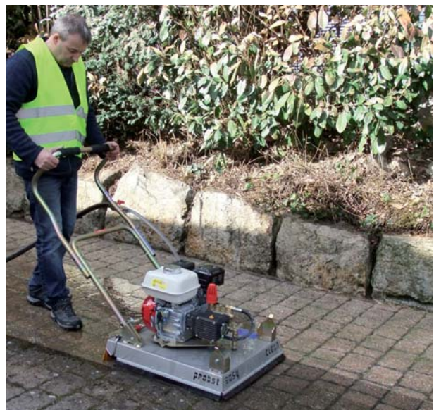
EASYCLEAN EC-60 Myjka wysokociśnieniowa do czyszczenia kostki i płyt
