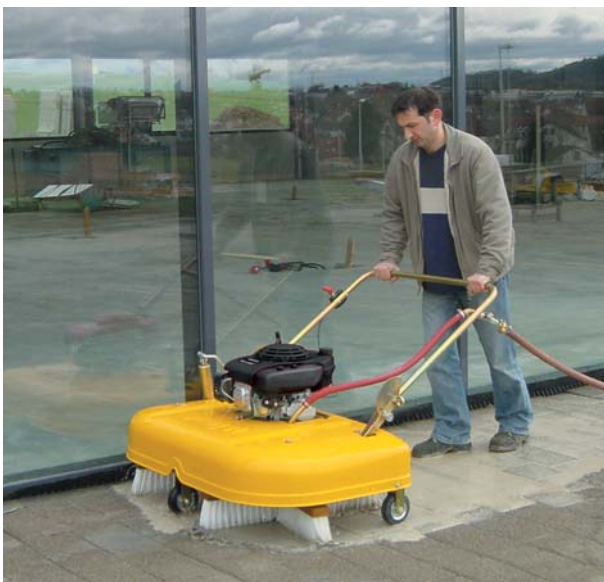
EASYFILL EF-H Urządzenia do fugownia kostki
