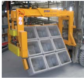
Chwytnak widłowy STAZ wyposażony w obrotowe zaciski 180°
