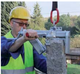
Chwytek do palisad granitowych SLS-8/20-G-VA
