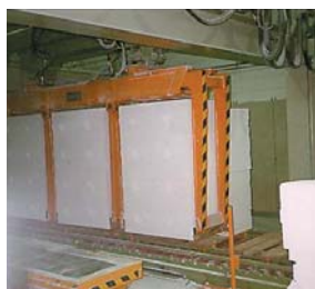
Chwytnak pakietujący STAZ z hydrauliczną przegrodą
