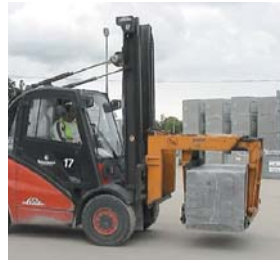
Chwytnak montowany do wózka widłowego STAZ-KA
