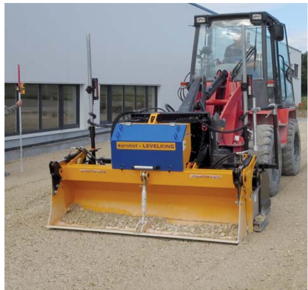
Osprzęt do niwelacji LEVELKING LK z szuflą składaną KS
