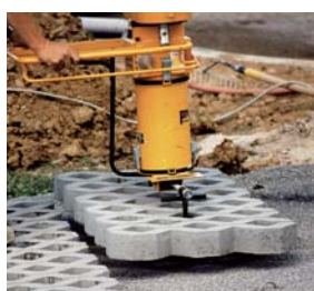
Chwytnak do układania płyt ażurowych RG-VZ
