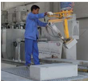
Obrotowa płyta ssąca z cylindrem pneumatycznym ESP-SW-P
