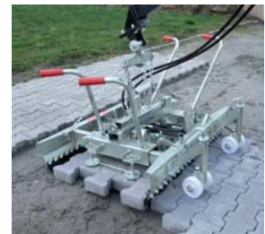
HVZ-LIGHT Chwytnak hydrauliczny do układania kostki
