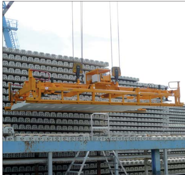
Chwytnak do układania betonowych podkładów kolejowych
