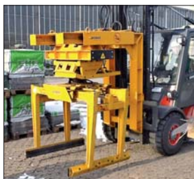
Chwytnak widłowy z wysięgnikiem i suwakami bocznymi
