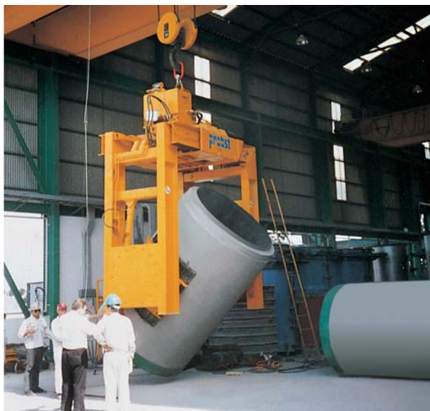
Suwnicowy chwytak obrotowy do rur betonowych PWG-R
