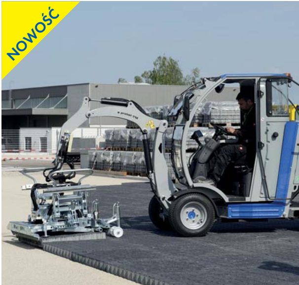
VM-X-PAVERMAX premium z HVZ-UNI-II Maszyna do mechanicznego układania kostki
