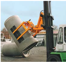
Przyrząd do obracania rur betonowych UG
