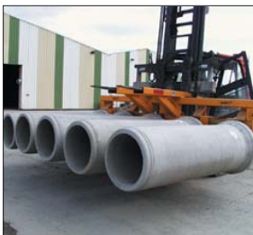
Hydraulicznie regulowany chwytak wielowidłowy MFD-UNI
