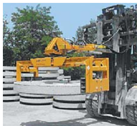
Chwytnak STAZ do pokryw montowany na wózku
