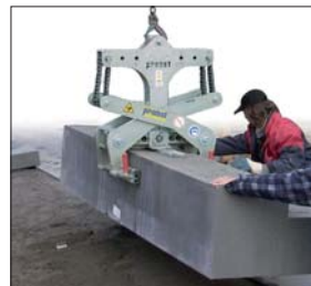
Chwytek do prefabrykatów betonowych FTZ-UNI-50
