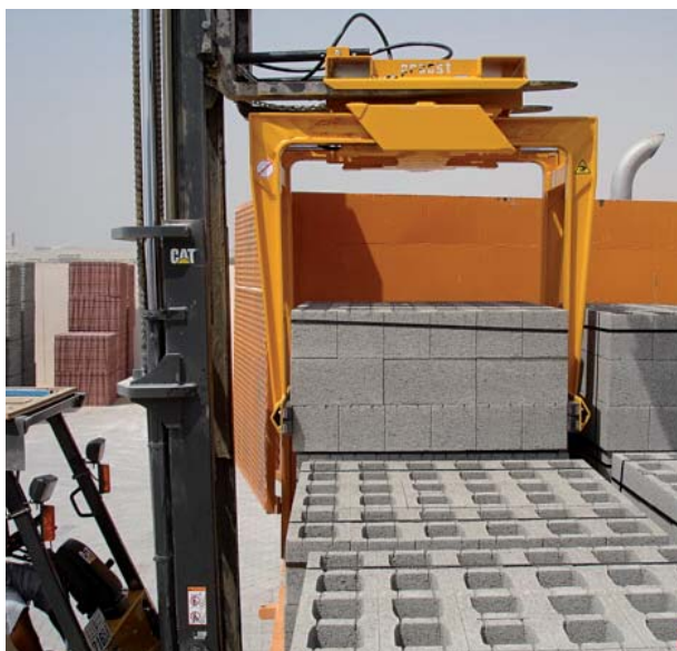
Adapter ET-E-4 do montażu chwytaków na wózkach widłowych
