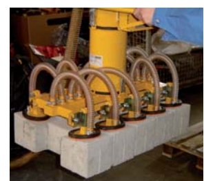
Chwytnak podciśnieniowy do układania betonowych bloczków
