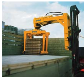
Chwytnak z teleskopowo rozsuwanym wysięgnikiem STAZ+KA+VA
