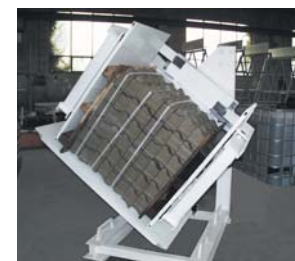
Hydrauliczny przyrząd do obracania palet WT-P
