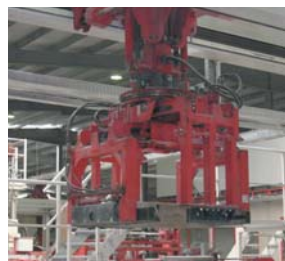
Hydrauliczny chwytnak pakietujący z obrotowymi zaciskami – zakres obrotu 180°
