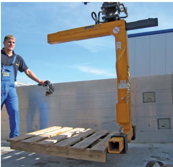
Chwyta widłowy do palet z łańcuchem zabezpieczającym PGH-K
