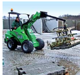
Chwytnak hydrauliczny do układania kostki przy miniladowarce
