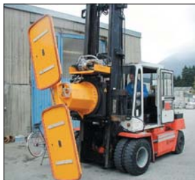
Przyrząd podciśnieniowy do obracania montowany do wózka
