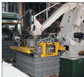
ROBOGRIP P-4 Chwytnak pneumatyczny montowany do robota P-4
