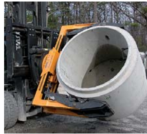
Przyrząd do obracania osadników betonowych WG-S
