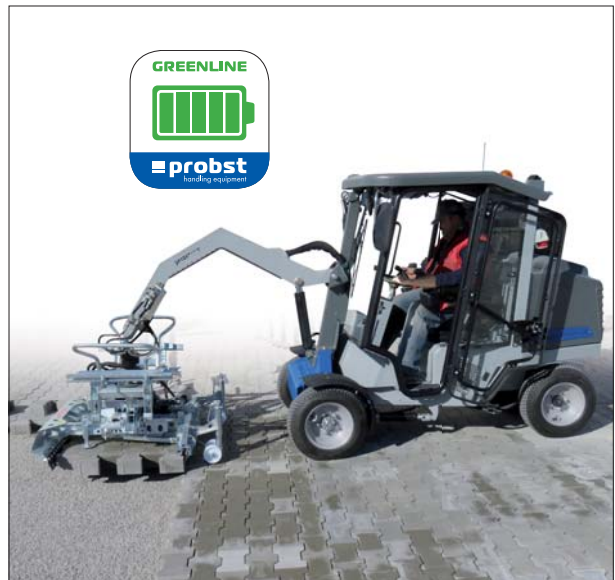
Maszyna do mechanicznego układania kostki VM-301-GREENLINE z HVZ-UNI-II
