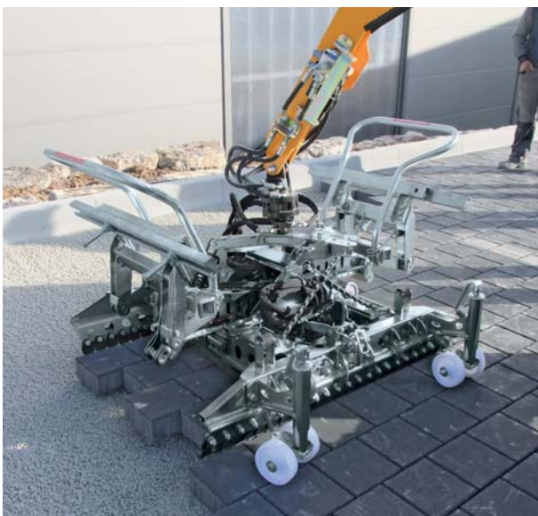
HVZ-UNI-II Chwytnak hydrauliczny do układania kostki
