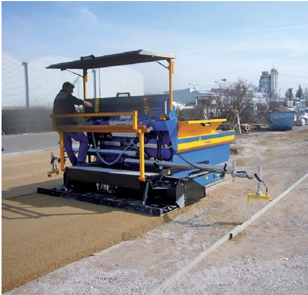
POWERPLAN PP maszyna do rozścielania i automatycznego niwelowania podsypki
