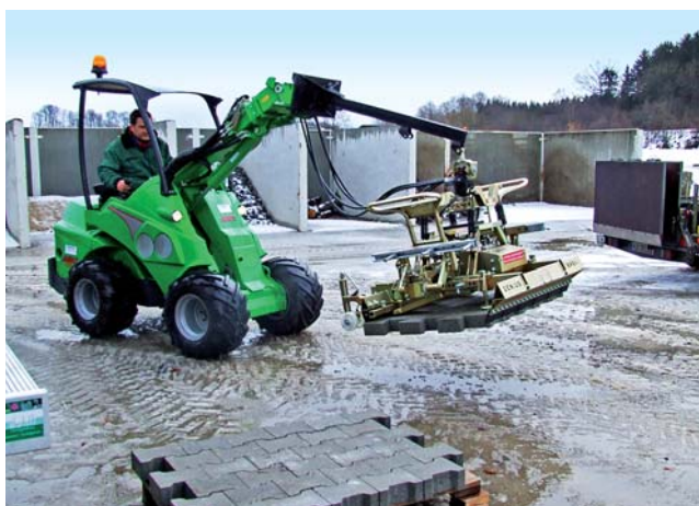
Pinza per la posa in combinazione con mini-escavatore
