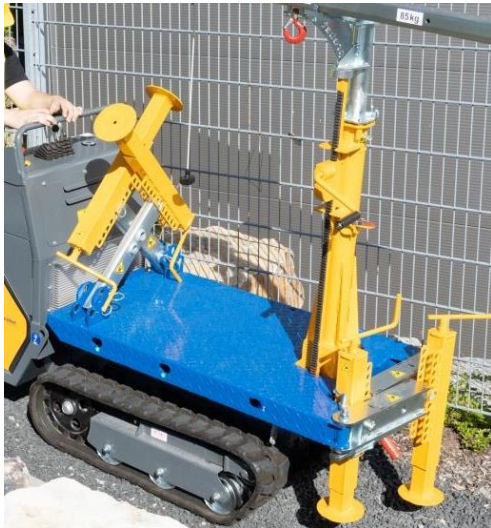
Parkposition (mit angebautem Raupenfahrgestell. ohne Last am Knickausleger)
