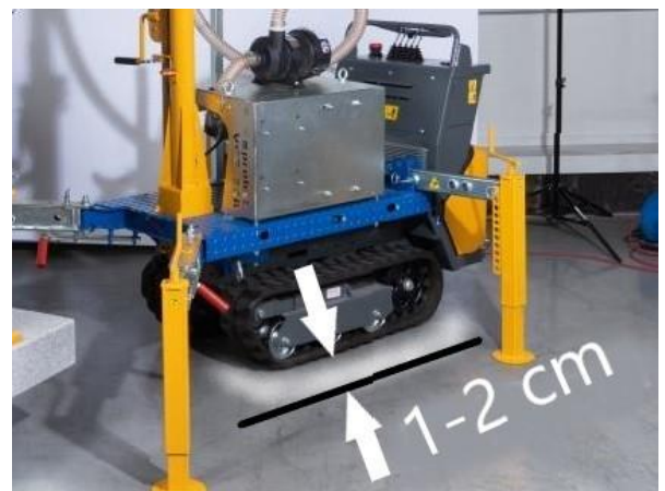
Arbeitsposition (mit Last am Knickausleger/Mindestabstand zwischen Boden u. Raupenfahrgestell von ca. 5 - 10 cm)
