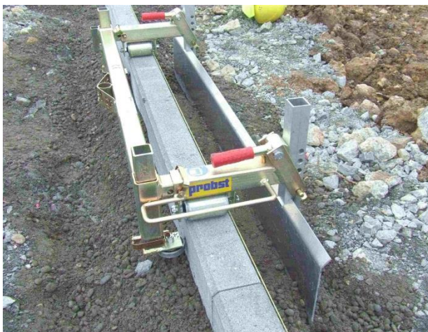
Feststellbremse in senkrechter Position zum Verschieben des Gerätes GR150 auf dem Bordstein
