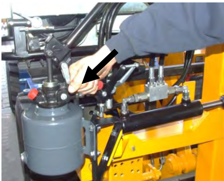
Roten Stellhebel in Position A bringen
