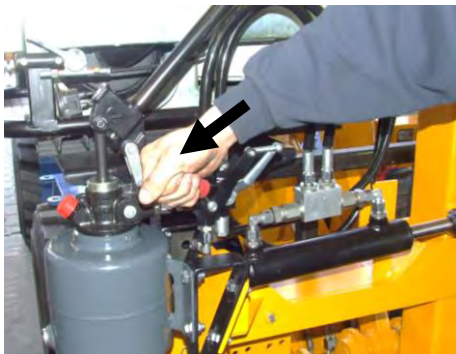
Roten Stellhebel in Position A bringen
