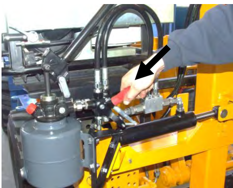
Roten Stellhebel in Position B bringen
