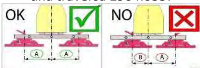
Nessun posizionamento decentrato delle piastre di aspirazione quando si utilizza una traversa 2904.0337
