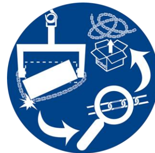
Yük, yük sabitleme zincirinin içine düşerse, zincir profesyonel olarak kontrol edilmeli ve gerekirse değiştirilmelidir. Hasarlı bir yük sabitleme zincirini kullanmaya devam etmeyin!
