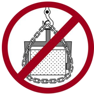
Yük sabitleme zinciri (bağlama zinciri) askı zinciri olarak kullanılmamalıdır! Yük sabitleme zinciri kırılabilir ve yük düşebilir! Yaralanma ve ölüm tehlikesi!
