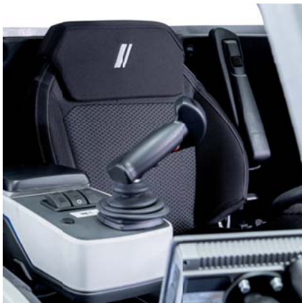
Joystick mit ergonomisch angeordneten Bedienelementen
