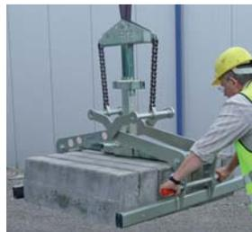
Pinza para prefabricados FTZ-MULTI-15-WB-G-120
