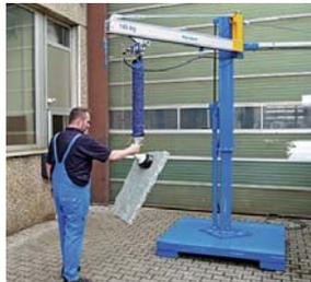
VACUSPEED VXS Sistema de elevación de manguera por vacío
