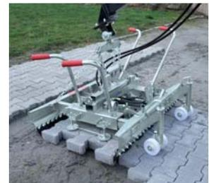
Pinza colocadora hidráulica HVZ-LIGHT
