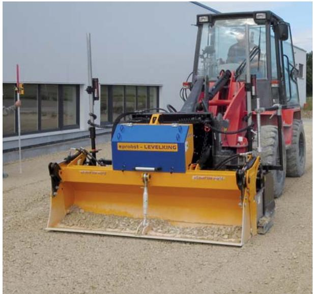
LEVELKING LK Accesorio de nivelado con pala plegable KS
