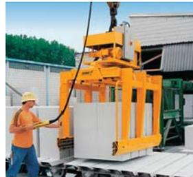
Pinza para caliza PKZ-KS para acoplar a puente grúa
