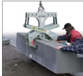
Pinza para prefabricados FTZ-UNI-50
