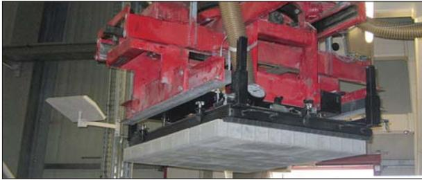
Dispositivo de aspiración por vacío de gran superficie FSG-UNI
