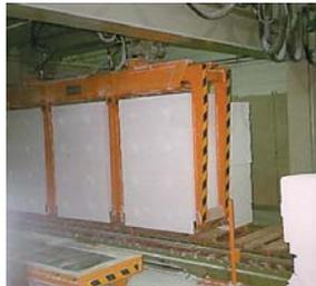
Pinza para Estibas STAZ con Separador Hidráulico
