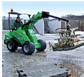
Pinza colocadora hidráulica combinada con mini excavadora
