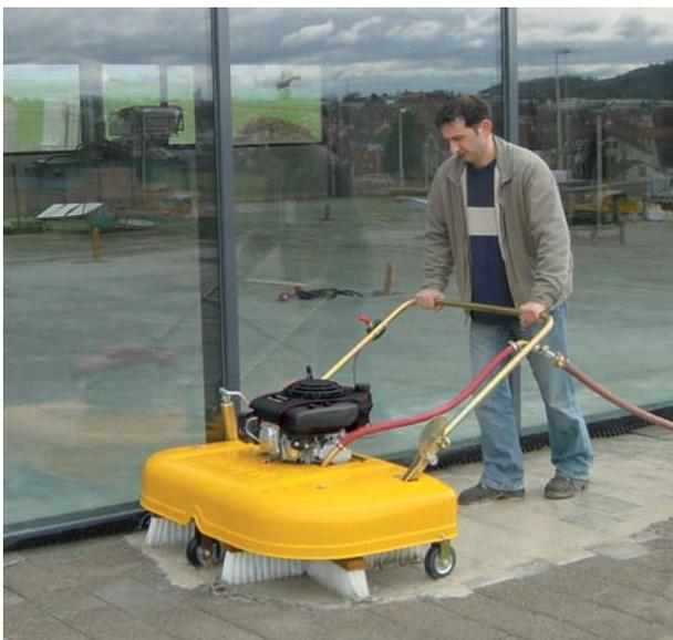
EASYFILL EF-H Aparato para rellenar juntas de adoquines
