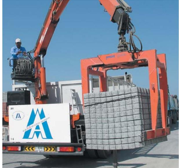
Pinza hidráulica para grúa del camión AKZ-UNI
