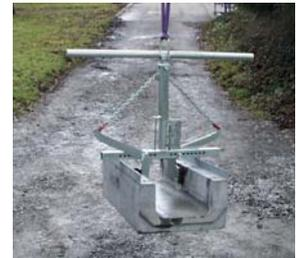
Pinza para Unidades para Muros de Contención Huecas FSZ-M
