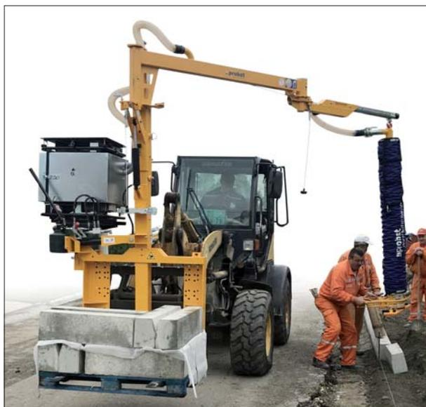
JUMBO-BV-VARIO Máquina colocadora de bordillos por vacío
