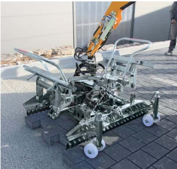
Pinza colocadora hidráulica HVZ-UNI-II
