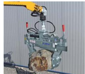
Pinza hidráulica colocadora de bordillos VZ-H-UNI
