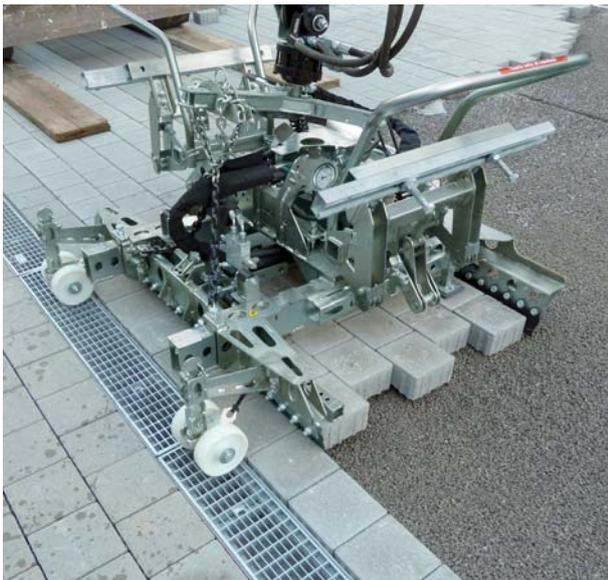
HVZ-ECO Pinza colocadora hidráulica
