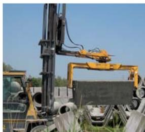
Pinza para extensión de horquillas STAZ para elementos de hormigon
