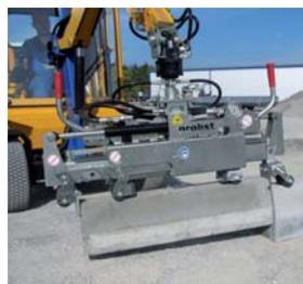
Pinza hidráulica colocadora de bordillos VZ-H-UNI
