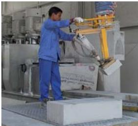
Placa de elevación por vacío giratoria con cilindro neumático ESP-SW-P
