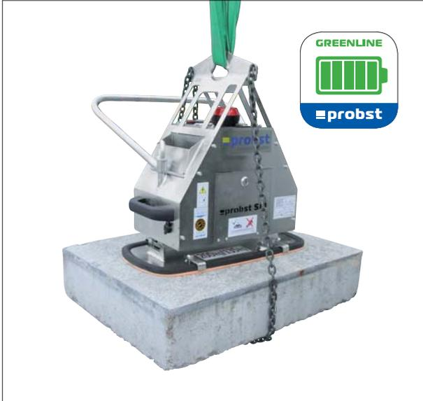
STONEMAGNET SM-600-GREENLINE-POWER Equipo de incorporación por Vacío
