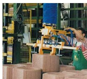
Sistema de elevación de manguera por vacío con pinza de clasificación ASZ-P
