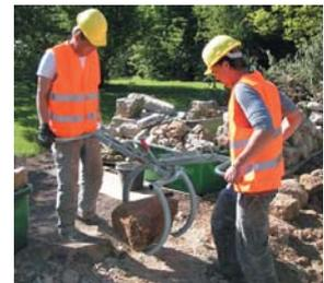
Pinza de colocación de rocas manual H-FVZ-UNI
