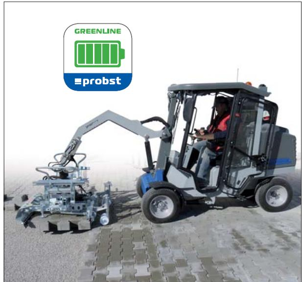
Máquina de colocación de adoquines VM-301-GREENLINE con HVZ-UNI-II
