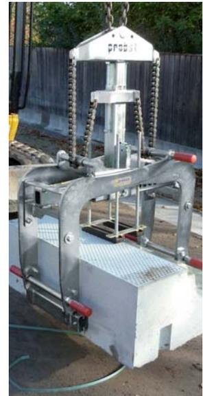
Pinza para prefabricados FTZ-MULTI-15-D-WB-G-42
