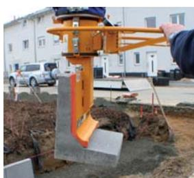
Placa de succión especial para productos de hormigón angulares
