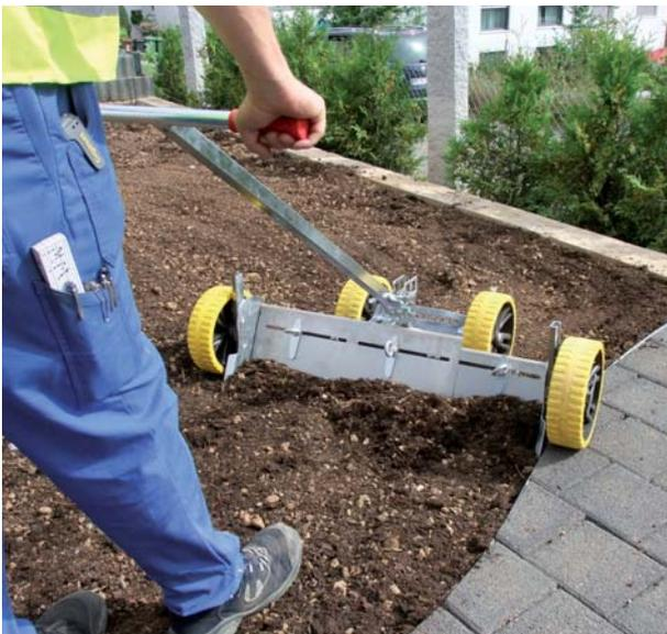
LEVELFIX LF-75/125 Sistema de nivelado manual
