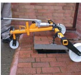
Sistema de levantamiento de tapaderas de pozos SDH-H-15
