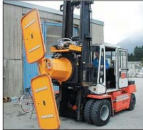
Dispositivo de Volteo por Vacío para Cargador de Tenedor
