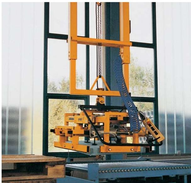
Pinza neumática para horquillas ATZ-P con SRF
