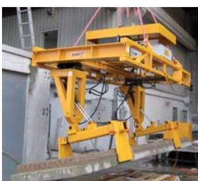
Dispositivo de montaje para muros de protección de ruido
