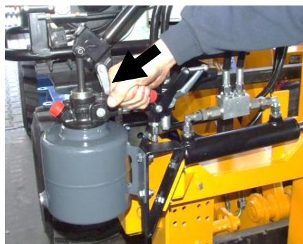
Mueva la palanca de ajuste roja a la posición A
