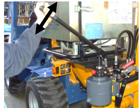
Betätigung der Handpumpe senkt den Mast ab .
