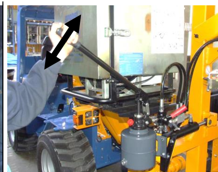
Al accionar la bomba manual, el mástil se desplaza hacia la izquierda.
