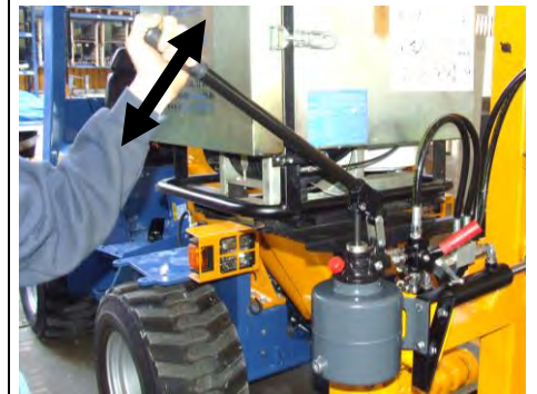
Betätigung der Handpumpe richtet den Mast auf.
