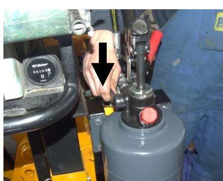
Mueva la palanca de ajuste de la bomba manual a la posición I
