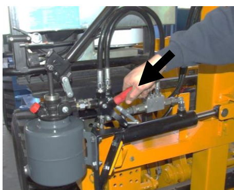
Mueva la palanca de ajuste roja a la posición B
