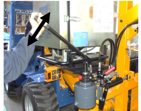
Accionando la bomba manual se baja el mástil.
