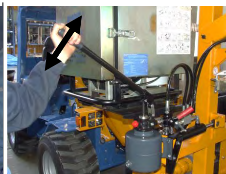
Betätigung der Handpumpe bewegt den Mast nach links.
