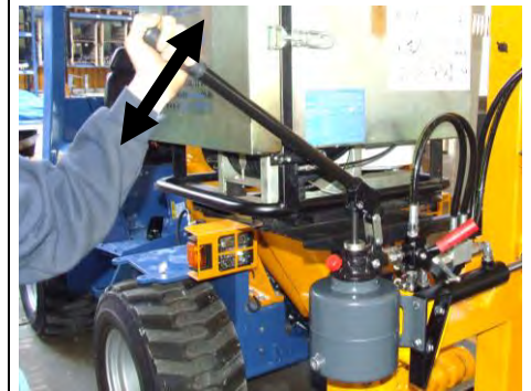
Betätigung der Handpumpe richtet den Mast auf.
