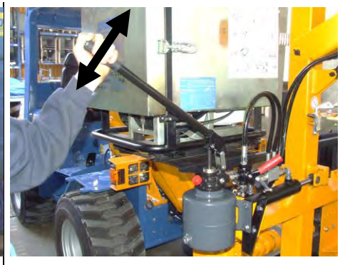
Betätigung der Handpumpe bewegt den Mast nach rechts.
