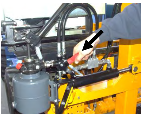
Roten Stellhebel in Position B bringen
