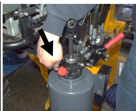
Przesuń dźwignię regulacyjną na pompce ręcznej do pozycji II
