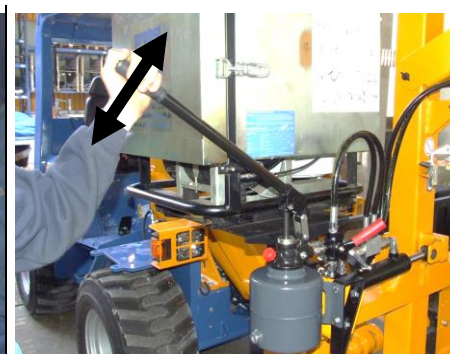
Uruchomienie pompy ręcznej powoduje przesunięcie masztu w lewo.
