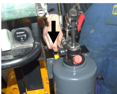
Przesuń dźwignię regulacyjną na pompce ręcznej do pozycji I
