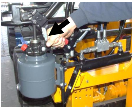
Przesuń czerwoną dźwignię ustawień do pozycji A
