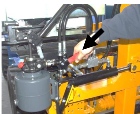
Przesuń czerwoną dźwignię ustawień do pozycji B
