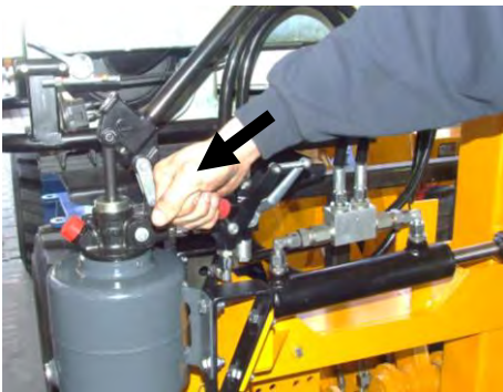
Roten Stellhebel in Position A bringen
