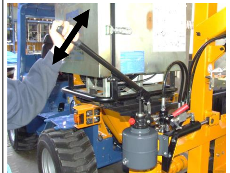
Uruchomienie pompy ręcznej powoduje podniesienie masztu.
